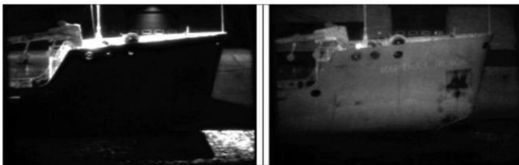
Рис. 4. Сравнение качества изображения, создаваемого обычной низкоуровневой ТВС (а) и АИ ТВС (б).
